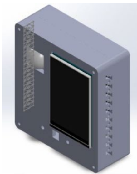
Figura 45.- Ensamblaje realizado en SolidWork para verificación del módulo Pi.
