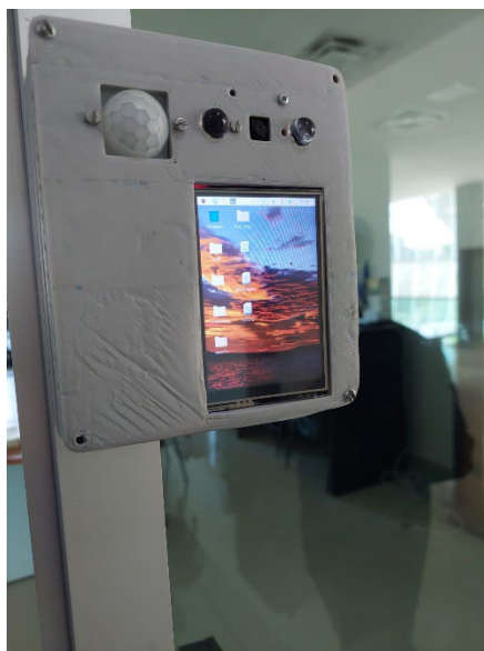
Figura 64.- Inicialización correcta del Módulo Pi.
