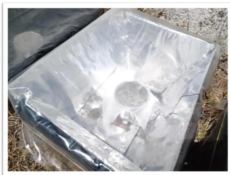
FIGURA 7 Muestras de heces dispuestas en horno con láminas de refracción concéntricas con cubierta de polipropileno.
