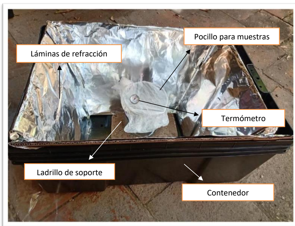
FIGURA 4 Diseño de horno solar donde se muestran sus componentes, en este modelo se observan las láminas de refracción de aluminio.
