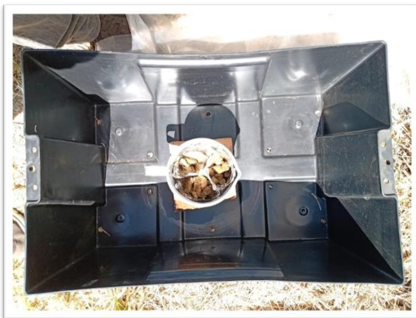
FIGURA 6 Muestras de heces en horno sin láminas de refracción concéntricas.
