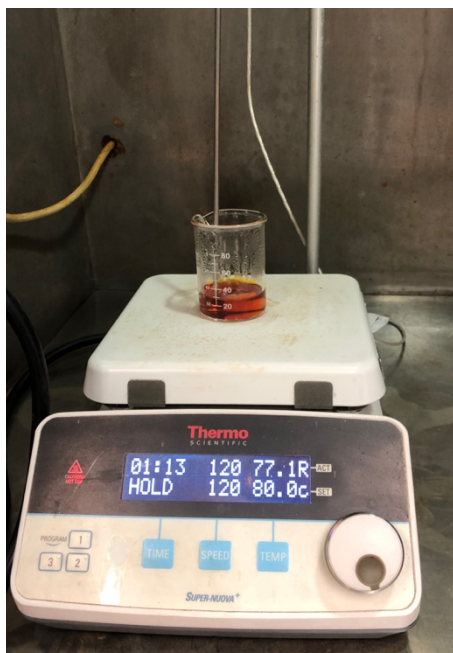
Figura 11. Condensación de una solución utilizada para síntesis sol-gel.
