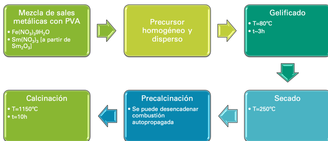
Figura 5. Ruta de síntesis para el método sol-gel + PVA.
