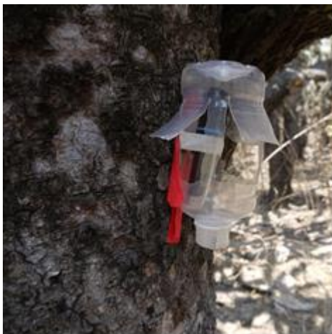
Figura 14. Estación microclimática compuesta de un “data logger” (El-USB-2-LCD) dentro de un contenedor de plástico, sujeto a una palma china ( Yucca decipiens ).
