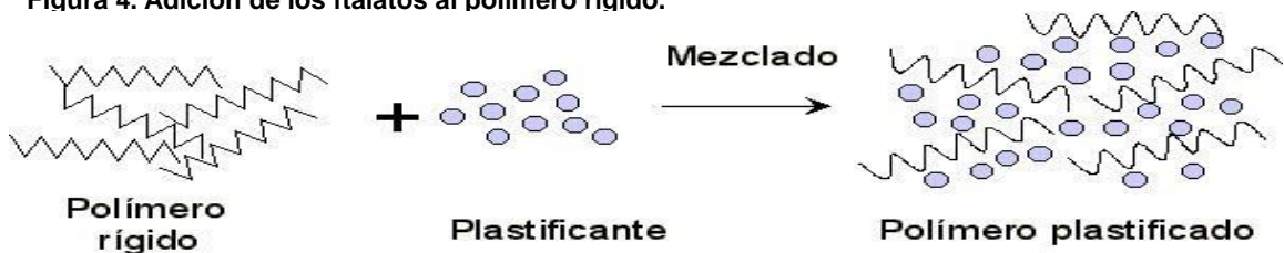
Figura 4. Adición de los ftalatos al polímero rígido.
