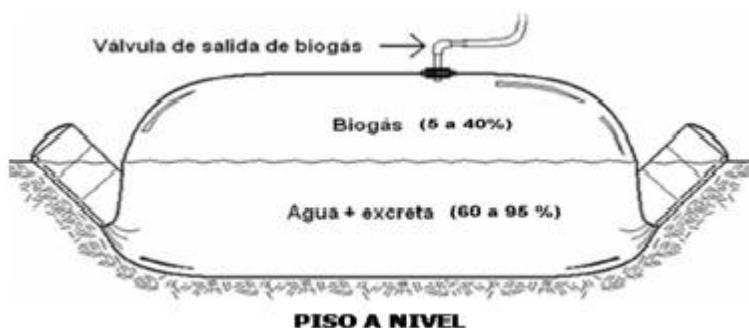
Estructura del biodigestor tipo estructura flexible.
