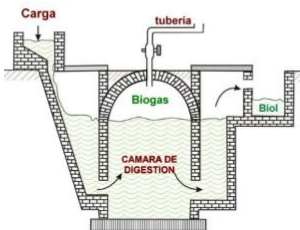
Estructura del biodigestor tipo domo fijo.
