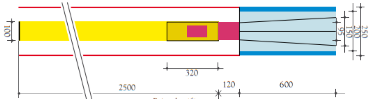
Vista aparato y pista en planta
