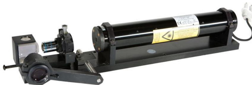
Figura 5. Dispositivo láser He-Ne para el tratamiento de irradiación de las semillas.
